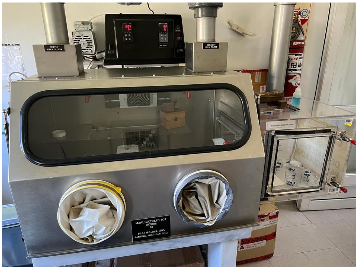
Figura IV.5. Cámara de pesaje de material particulado que emite un vehículo
